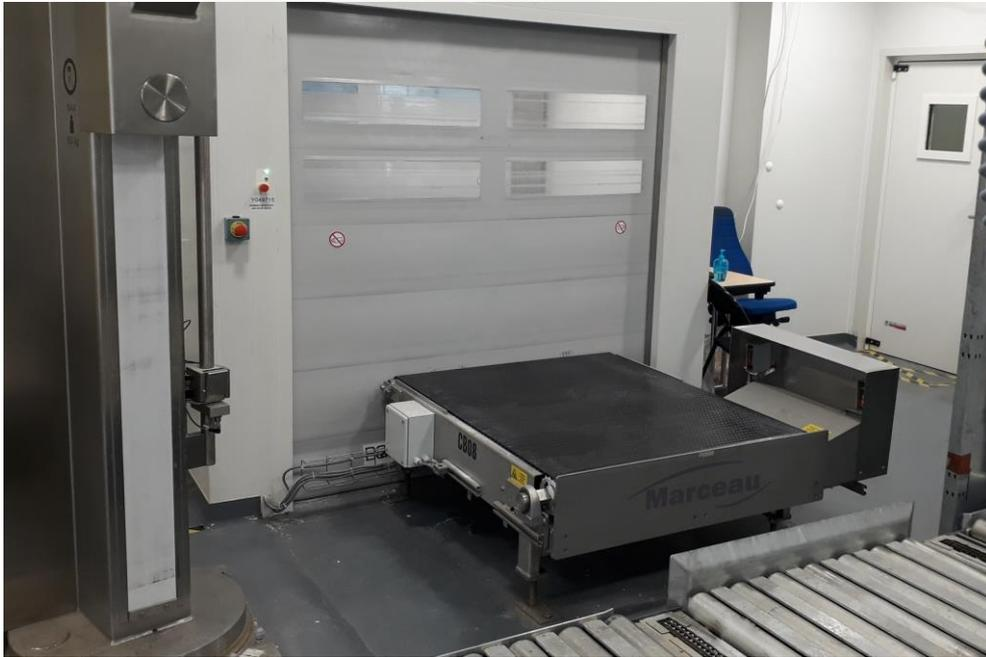
13219 228 Sortie salle blanche sur convoyeur à bandes modulaires
