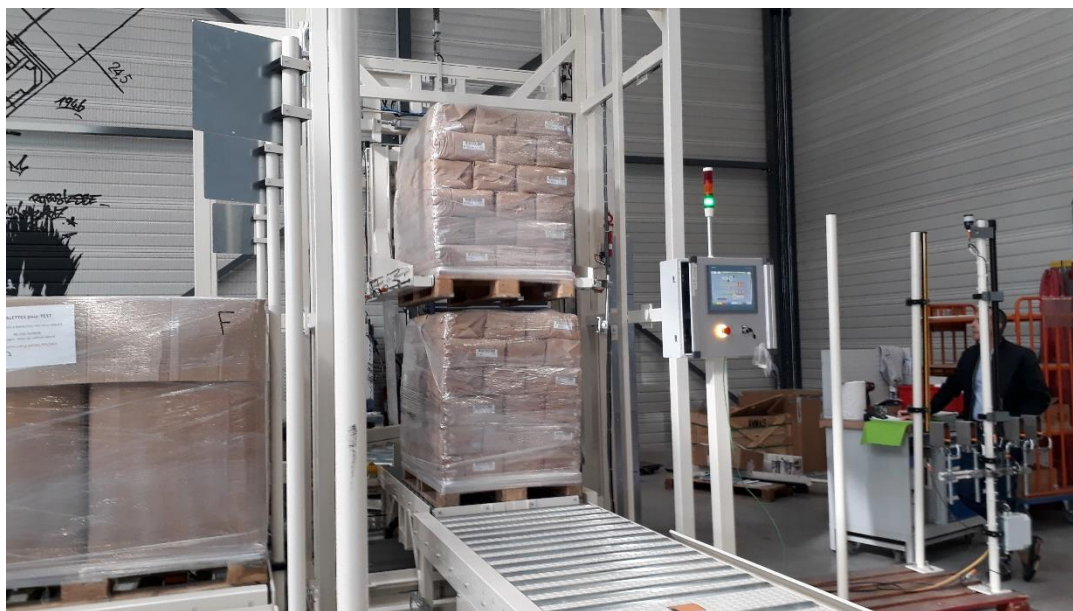
11944 065 Gerbeur positionnant la palette supérieure par rapport à la charge inférieure
