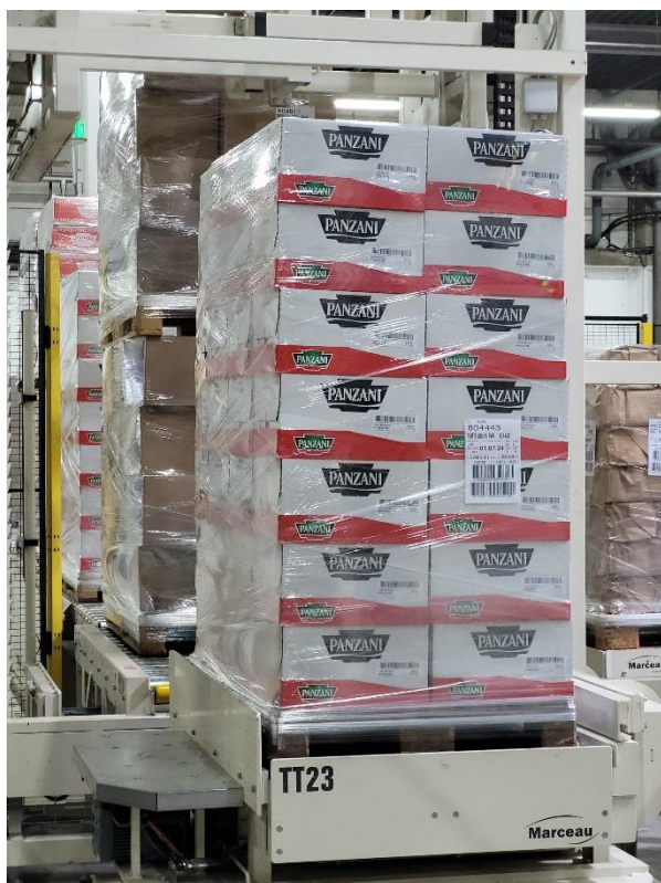
11944 212 Poste de reprise palette non conforme
