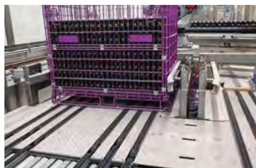
TFC 100-6 Transfert à cames haute cadence pour passage caisses fils.
