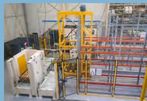
NAF 100 Navette à fourches télescopiques multiniveau.
