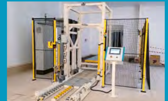
CN 80 Changement de niveau pour dépose/ reprise au transpalette.
