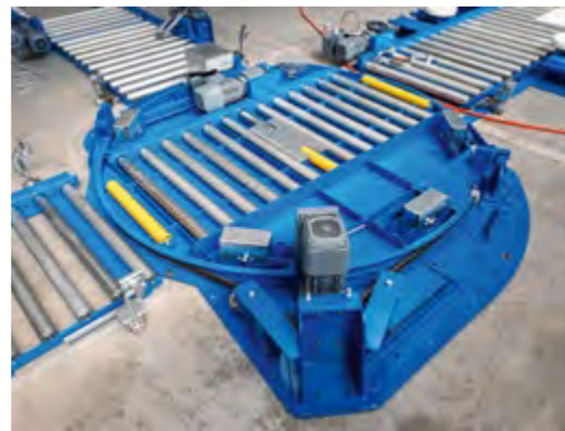
TTRM 80 Table tournante faible hauteur.
