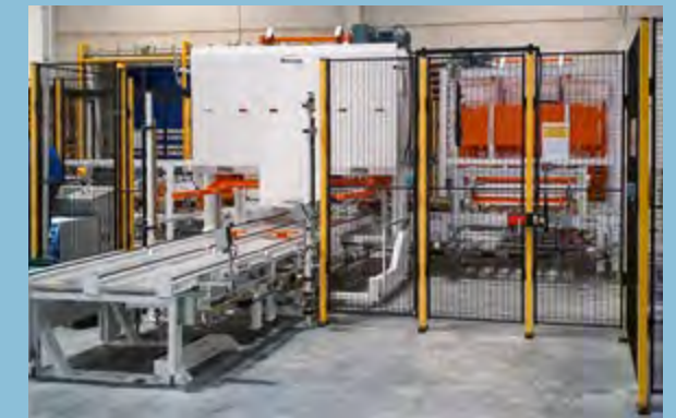
MP-V Ligne de contrôle palettes haute cadence (250 p/h) milieu logistique.
