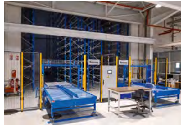
MP-C Contrôle palettes de produits plats métalliques pour l'industrie aéronautique.
