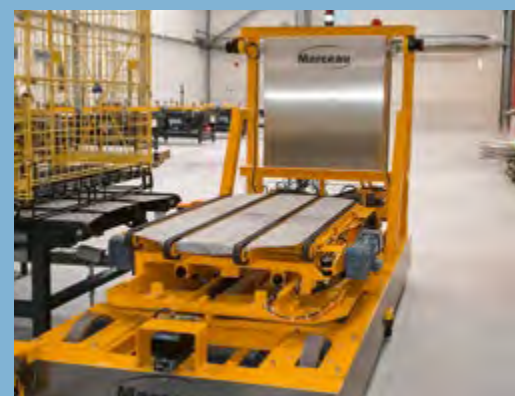
TBCC 100 Navette à induction pour liaison complexe.
