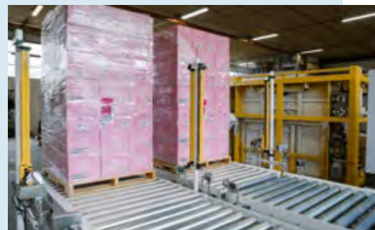
CRM 100 Convoyeur à rouleaux motorisés standard.
