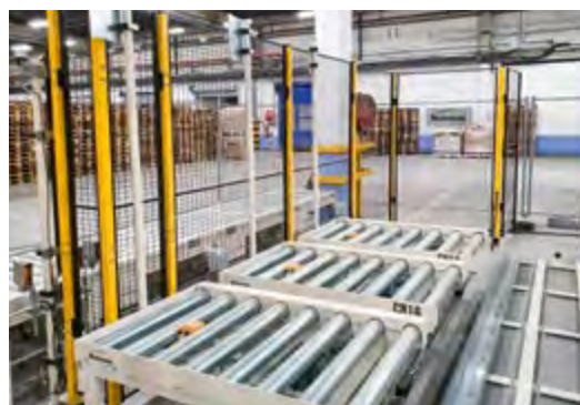
CRM 100 Convoyeur à rouleaux motorisés standard.
