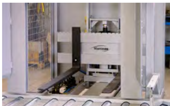
DPF 100 Dépileur à fourches multiformat.
