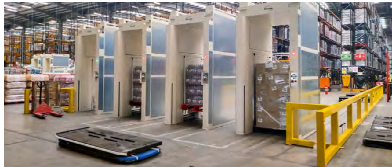
Permupal®: dépose au transpalette et reprise par AMR
