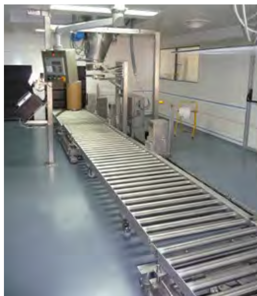
Ensemble CRM 100-I Ligne de remplissage de fûts et conteneurs avec pesage intégré. Zone Atex.
