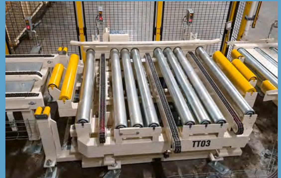
TTT Table tournante transfert double mouvement.
