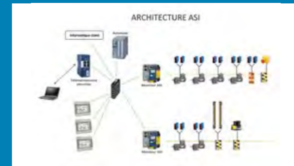
Câblage architecture ASI Utilisation de BUS de terrain.
