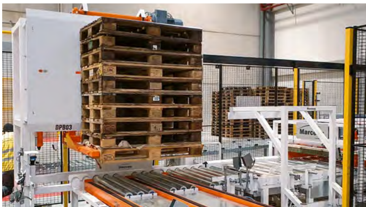
DPB 100-15 Dépileur à bras haute cadence multiformat.
