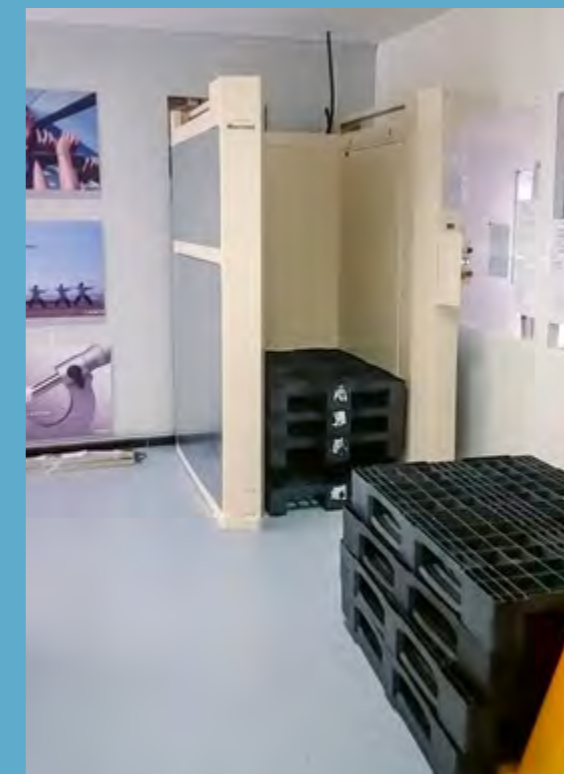
DPB 15*800 Dépileur de palettes format spécifique, milieu pharmaceutique.
