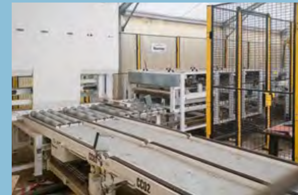
MP-V Ligne de tri qualité palettes multicritère pour l'industrie.
