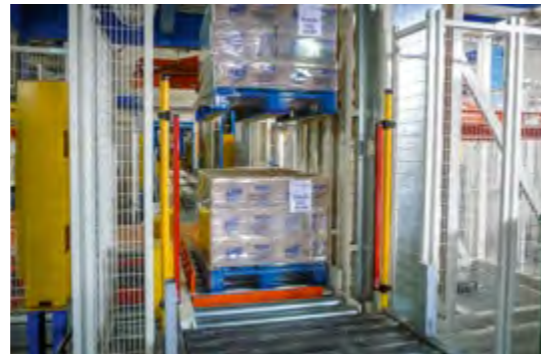
GBF 100 Gerbeur en sortie de ligne de banderolage avec suivi de palettes.
