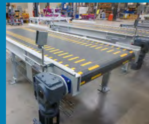
CBM Convoyeur à bandes modulaires pour palettes multiformats.
