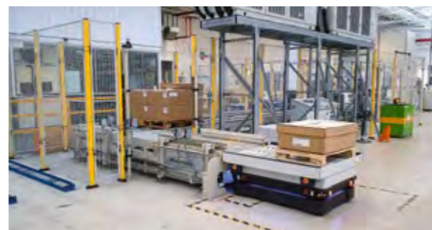
CRM 100 adapté au transfert de charge sur AMR
