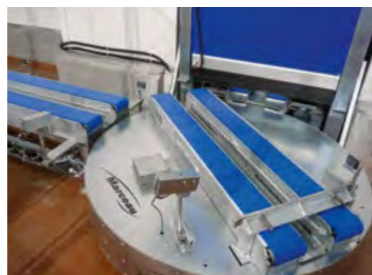
TTBM Table tournante avec convoyeur à bandes modulaires pour palettes plastiques.
