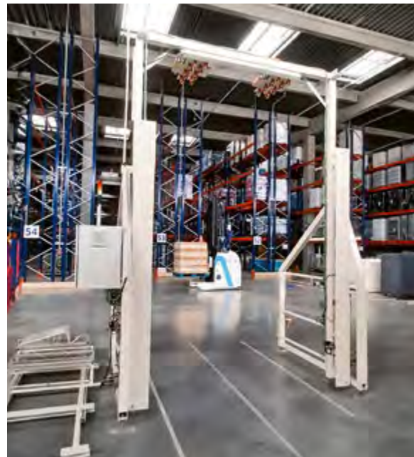
MP-C Contrôle dynamique de charge manutentionnée par AGV.
