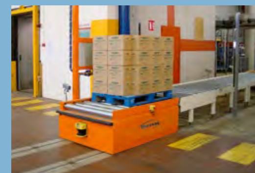
TBRM 100 Transbordeur standard à rouleaux motorisés.
