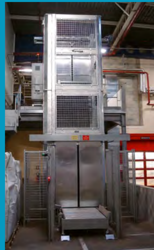
EL 100-G Élévateur pour palettes de big bag avec châssis galvanisé, milieu tropicalisé.
