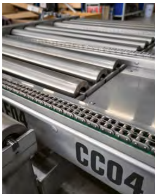
TFC 100-3 Transfert tri-chaînes pivotant.
